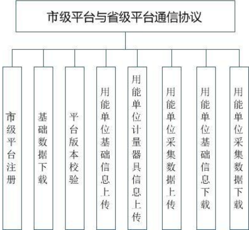
图 3 市级平台与省级平台通信协议构成
